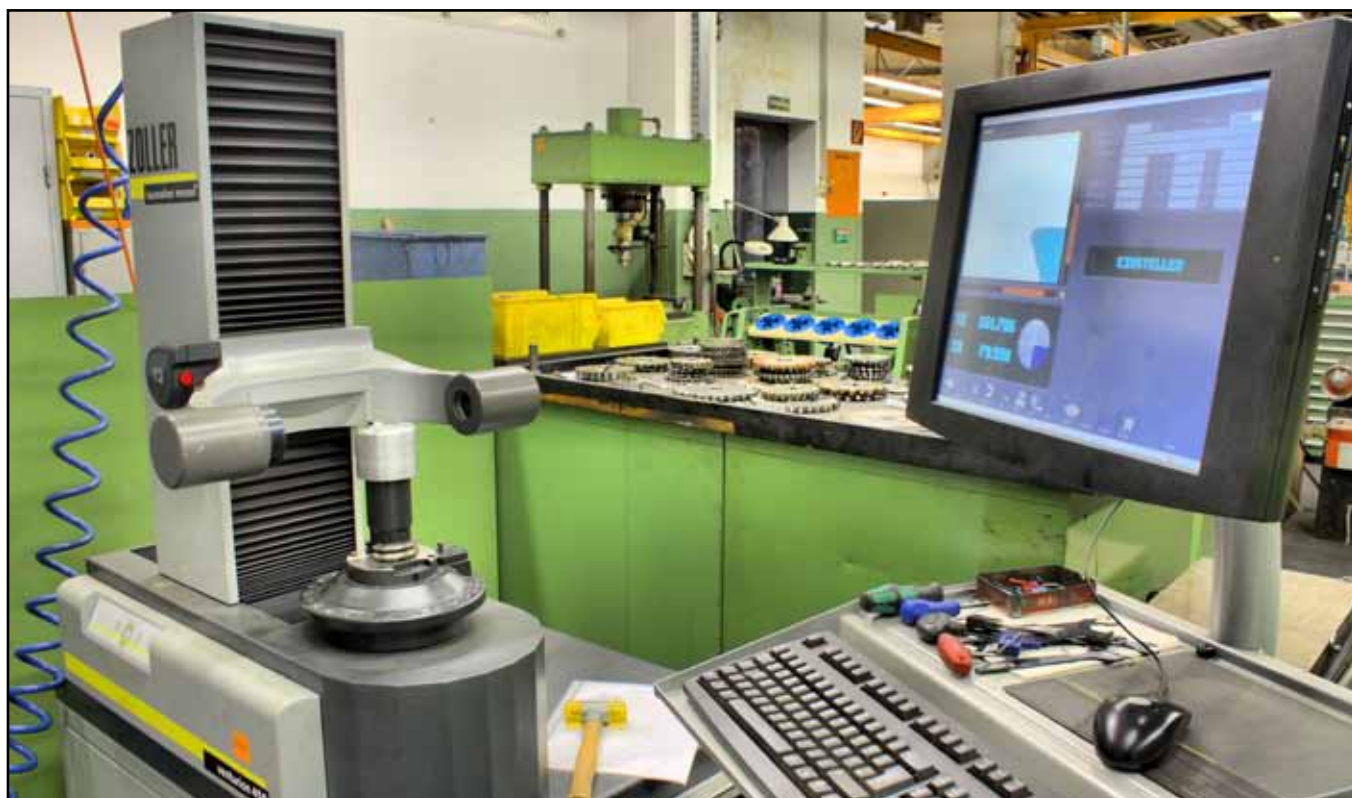
Ein modernes Voreinstellgerät von Zoller hilft, dass Edelmann-Druckmaschinen mit jedem Modell ihrem Ruf gerecht werden. Mit diesem Messgerät werden die Werkzeugmaße optisch in höchster Präzision ermittelt.
