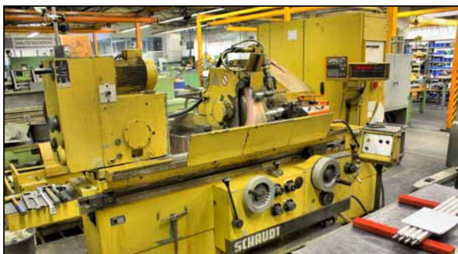
Die 1985 gebaute Schleifmaschine von Schaudt ist dank ständiger Wartung und bestem Maschinenbau auch heute noch ein wichtiges Produktionsmittel bei Edelmann.
